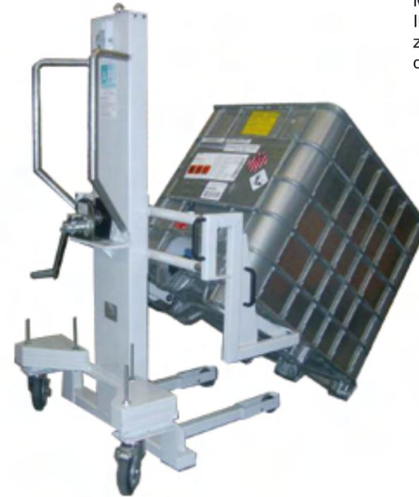
Container Kippstation mit elektro-hydraulischer Vollausrüstung. Der Greifer zentriert mit seiner Parallel-Verstelleinheit den Container selbsttätig. Die Drehfunktion kann aus Sicherheitsgründen nur mit einer Zweihandbedienung ausgeführt werden.
