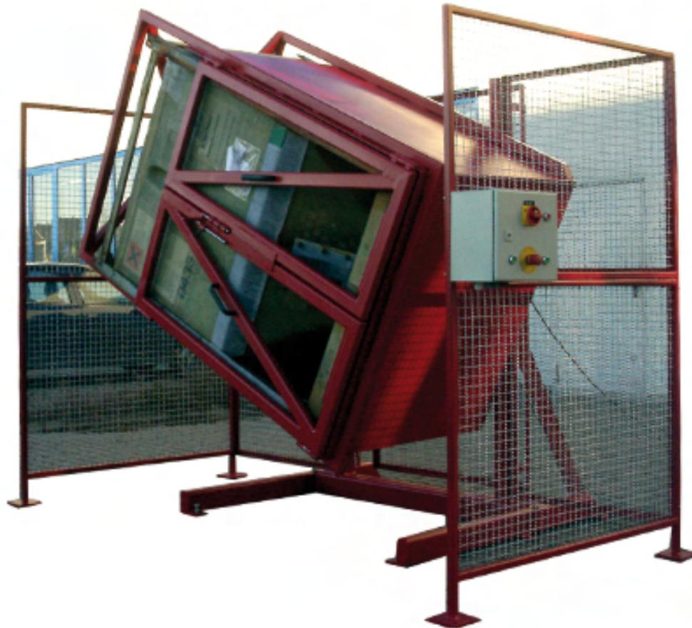
Manuelles Anheben und nach vorn kippen von IBC-Containern. Der Container ist mit Steckbolzen am Greifer gesichert. Der Hub erfolgt mit der Handseilwinde.
