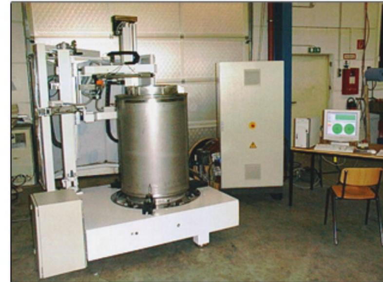
Ein zu messendes Fass wird ferngesteuert auf dem Drehteller der Maschine positioniert. Nach dem Programmstart fahren Meßsonden über den Deckel, den Boden und den Mantel des Fasses, während es sich dreht. Somit wird praktisch jeder Punkt der Oberfläche erfasst. Die Meßwerte werden anschließend visuell dargestellt.
