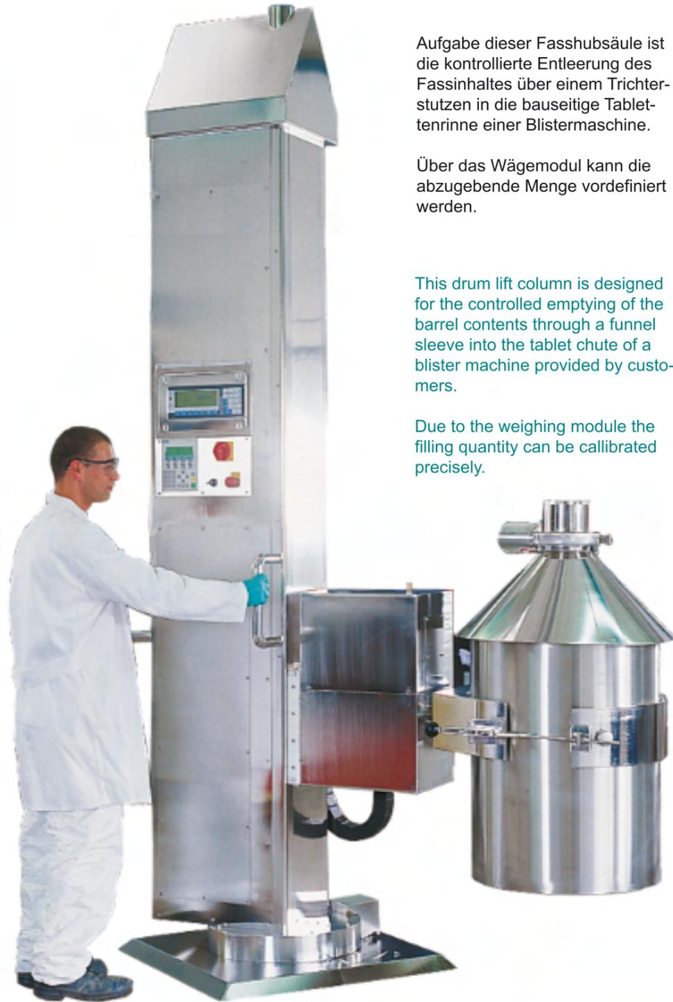
Aufgabe dieser Fasshubsäule ist die kontrollierte Entleerung des Fassinhaltes über einem Trichterstutzen in die bauseitige Tablettenrinne einer Blistermaschine.
