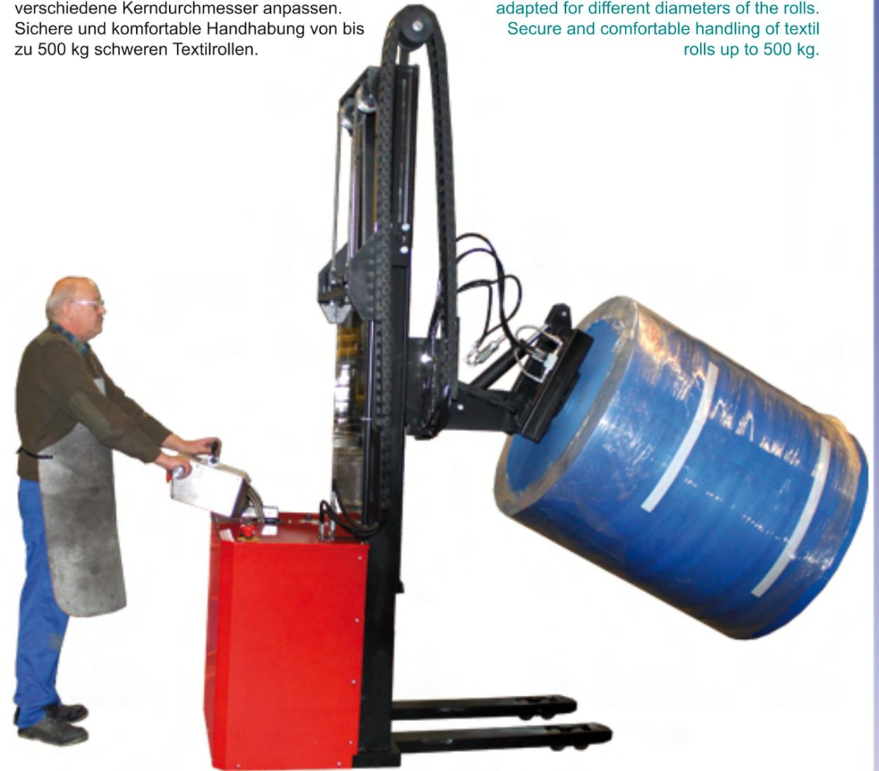
Mittels Kippmodul von 90° können die Rollen waagrecht oder senkrecht aufgenommen und abgesetzt werden. Mit wenigen Handgriffen kann der Adapter zur Aufnahme des größeren Kerns am Grunddorn angebracht werden und ermöglicht so das Handling der größeren Rollen.
